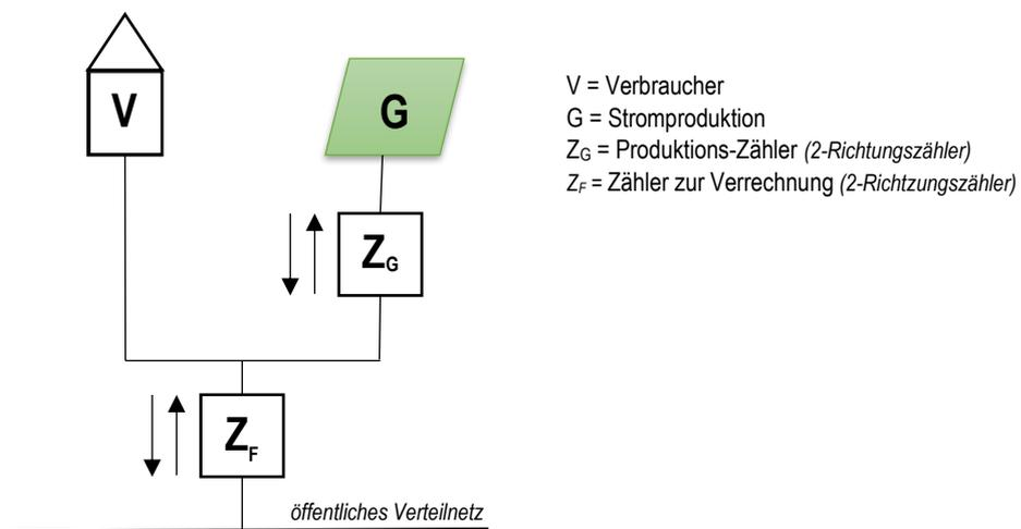
**Beispiel 4 Messung nach Eigenverbrauchsprinzip - Stromerzeugungsanlage über 30 kVA → Parallel**
