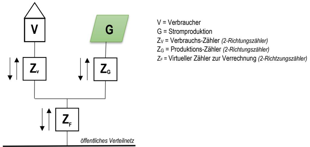
**Beispiel 5 Messung nach Eigenverbrauchsprinzip - mit Stromspeicher → aufladbar aus dem Verteilnetz**
